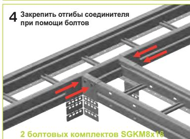
**4** Закрепить отгибы соединителя при помощи болтов
