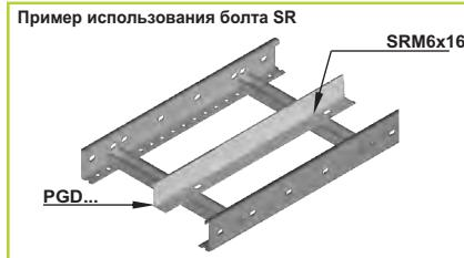
Пример использования перегородки PGDJ N с верхним соединителем LPG и нижним соединителем LPD
