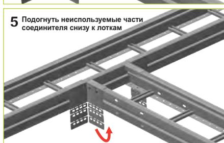
**5** Подогнуть неиспользуемые части соединителя снизу к лоткам
