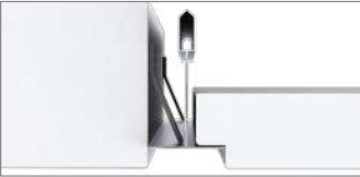
Varton для Vector Полускрытая система. Т-образная рейка частично скрыта.
